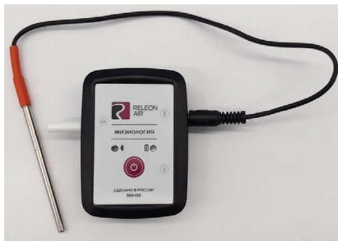
Рис. 12. Датчик температуры тела
