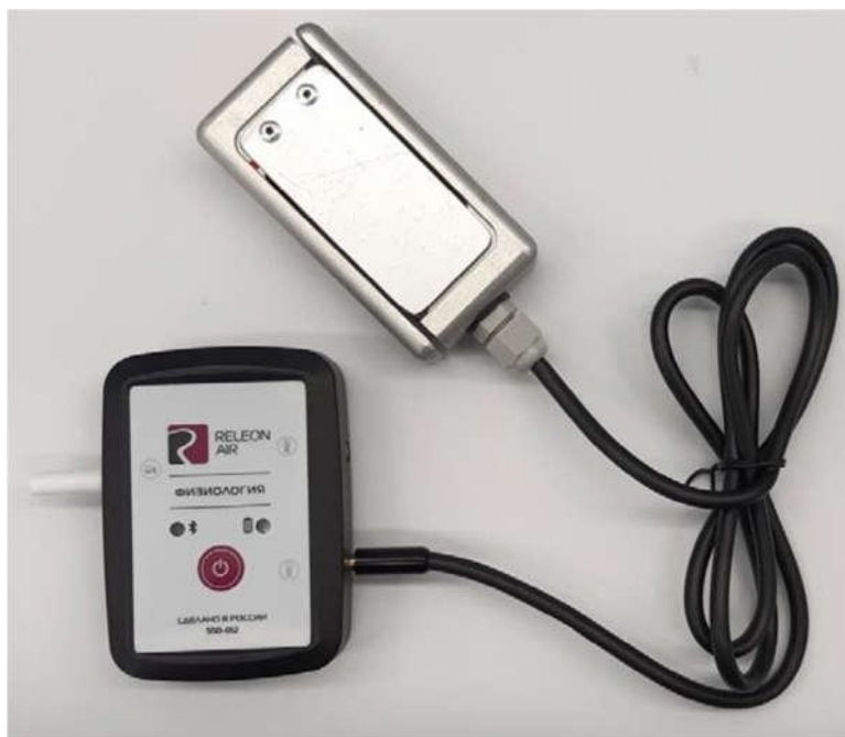
Рис. 17. Датчик кистевой силы (эргометр)
