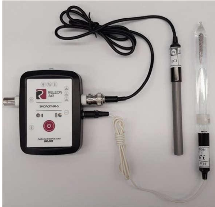
Рис. 10. Ионоселективный датчик (присоединены электрод хлорид-ионов и электрод сравнения)
