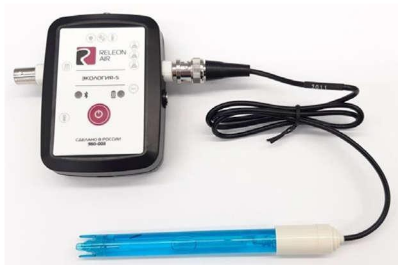
Рис. 9. Датчик водородного показателя (рН)
