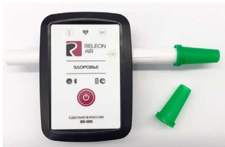
Рис 15. Датчик частоты дыхания
