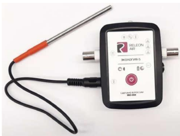
Рис. 6. Датчик температуры растворов
