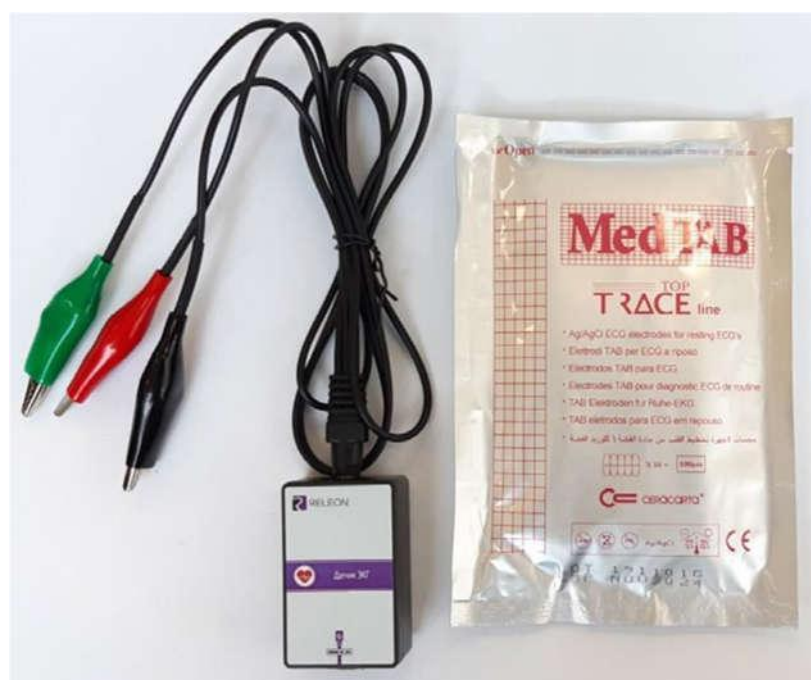
Рис. 16. Датчик электрокардиограммы (датчик ЭКГ)
