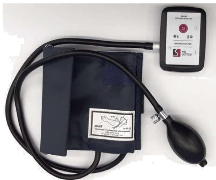
Рис. 13. Датчик артериального давления
