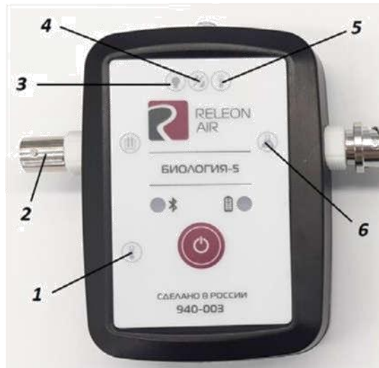
Рис. 2. Мультидатчик по биологии: 1 — температура растворов, 2 — электропроводность, 3 — освещённость, 4 — относительная влажность воздуха, 5 — температура окружающей среды, 6 — pH
