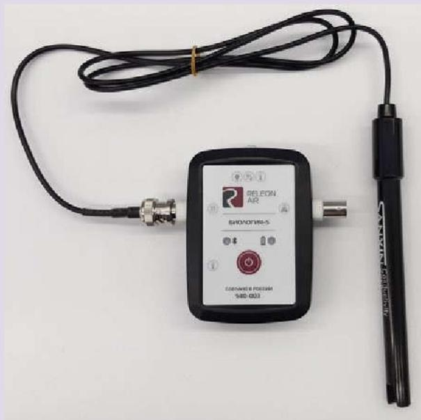
Рис. 5. Датчики электропроводимости
