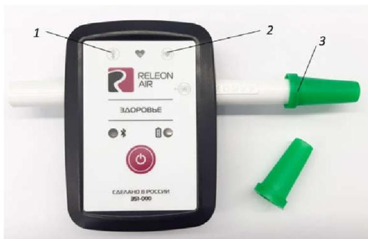
Рис. 3. Мультидатчик по физиологии. Обозначение разъемов и технологических отверстий: 1 — температура тела, 2 — пульс, 3 — частота дыхания (надет съёмный мундштук)
