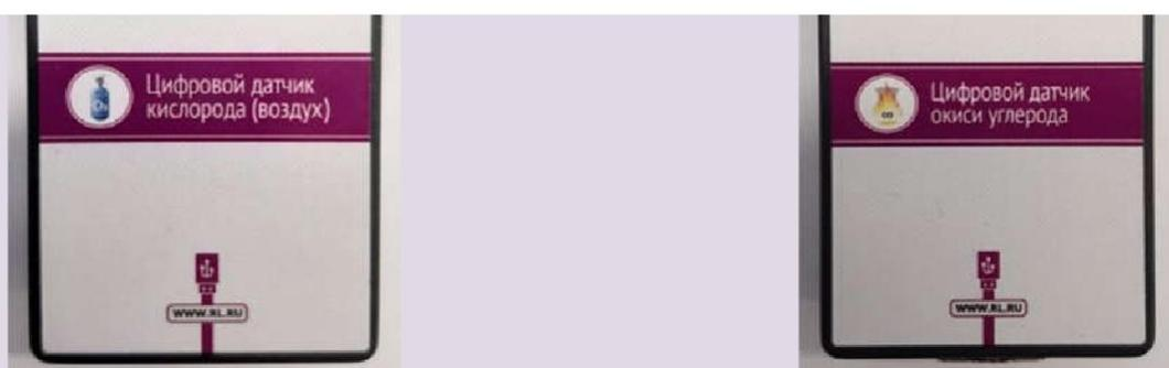
*Рис. 11.* Датчики кислорода (слева) и угарного газа (справа)
