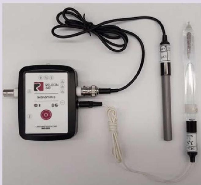
*Рис. 10.* Ионоселективный датчик
