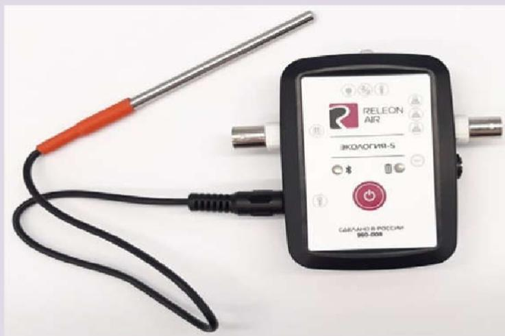
*Рис. 6. Датчик температуры растворов*
